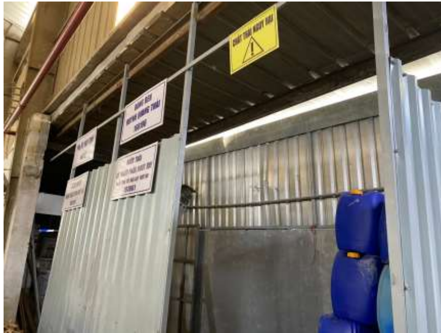
Hình 15. Khu vực lưu chứa nước thải rửa bồn in có dính thành phần nguy hại
